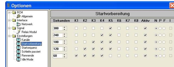
Für 5 verschiedene Bedingungen kann die Funktion eingestellt werden. In der linken Spalte stehen die Zeiten vor dem Start, bei denen die jeweilige Funktion ausgeführt wird. Unter den Kanälen K1 bis K8 werden die jeweiligen Lampen aktiviert, die ein- oder ausgeschaltet werden.
