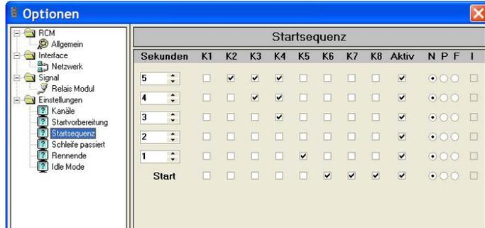
Für 5 verschiedene Bedingungen kann die Funktion eingestellt werden. In der linken Spalte stehen die Zeiten vor dem Start, bei denen die jeweilige Funktion ausgeführt wird. Unter den Kanälen K1 bis K8 werden die jeweiligen Lampen aktiviert, die ein- oder ausgeschaltet werden. Die Spalte Aktiv muss aktiviert sein, damit der Befehl ausgeführt wird. Die Spalten N, P und F bedeuten:
